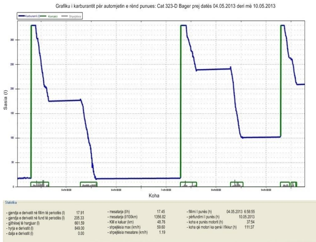
Fig. 58. Grafiku i rrjedhës së karburantit për automjetin e rëndë punues CAT 323-D Bager, dhe statistikën e fituar nga raporti automatik
