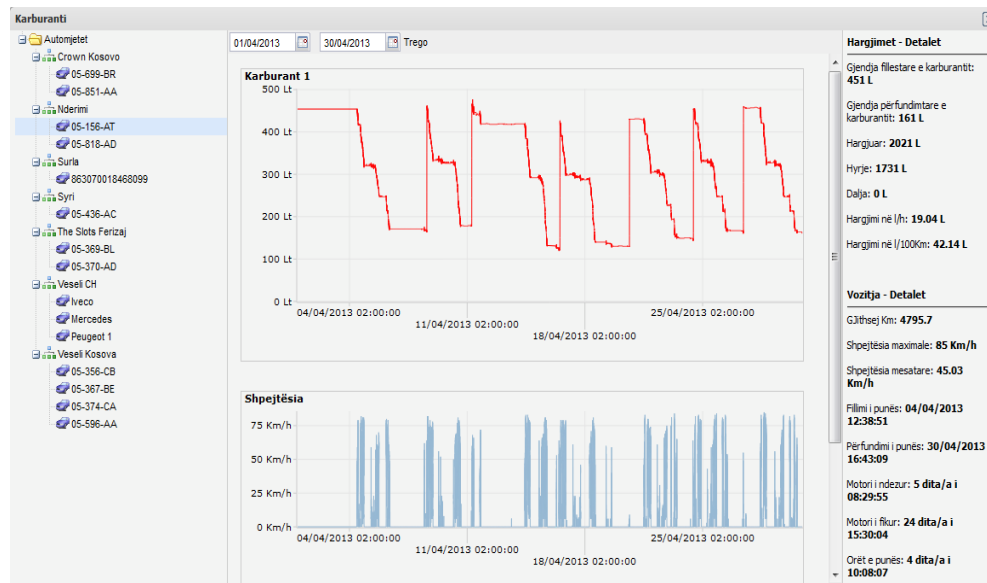
Fig.63. Grafiku i nxjerrë nga aplikimi për monitorim në distancë të rrjedhës së karburantit për automjetin 05-158-AT
