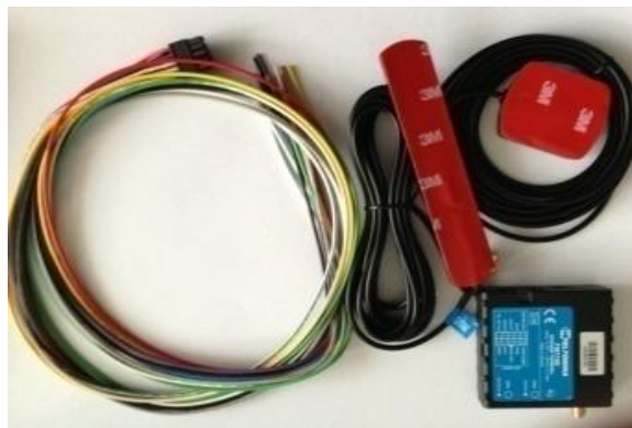
Fig. 47. Pjesët përbërëse të modulit FM1100
