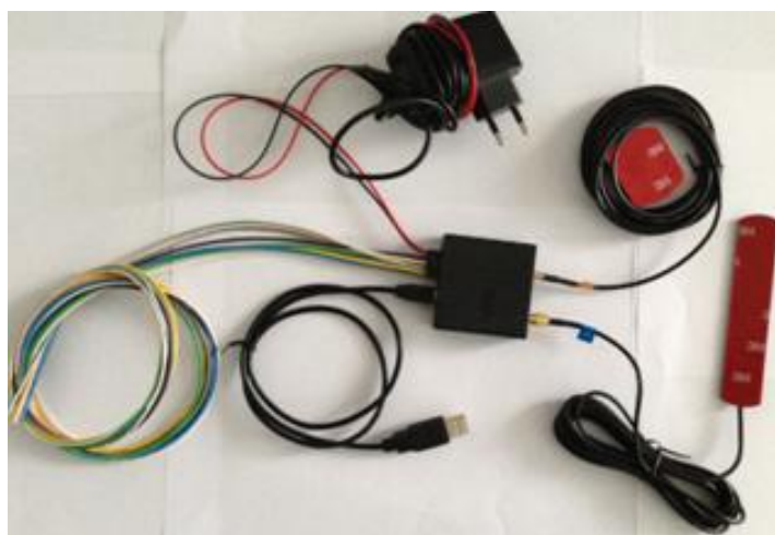
Fig. 33. Lidhja e moduleve të marrësit GPS, antenës dhe furnizimit
