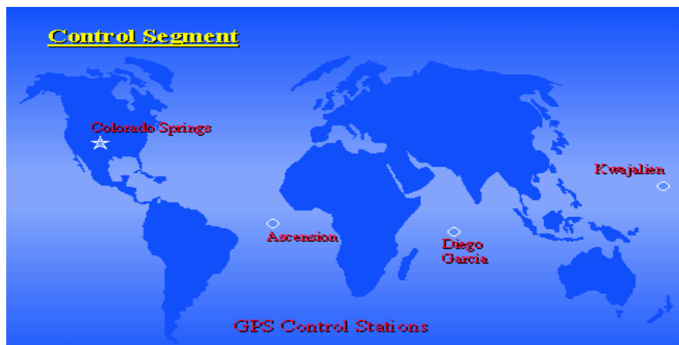
Fig. 17. b Rrjeti i stacioneve monitoruese dhe atij kontrolluese
