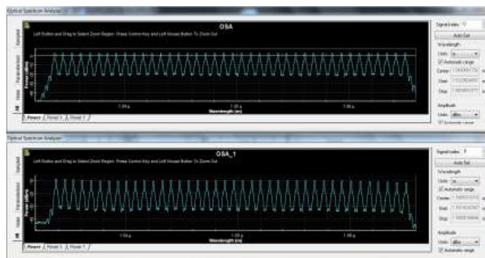
Figura 107. Matjet e bëra me optical spectrum analyzer në dalje të multiplekserit dhe në hyrje të demultiplekserit.
