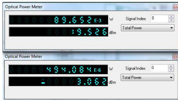
Figura 123. Fuqia e sinjalit transmetues në dalje të multiplekserit dhe në hyrje të demultiplekserit në transmetim sinjali me kapacitet 40 Gbps.
