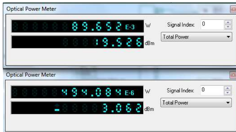
Figura 101. Fuqia e sinjalit transmetues në dalje të multiplekserit dhe në hyrje të demultiplekserit në transmetim të sinjalit me kapacitet 40 Gbps.
