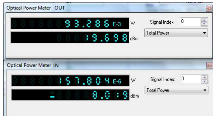
Figura 113. Fuqia e sinjalit transmetues në dalje të multiplekserit dhe në hyrje të demultiplekserit
