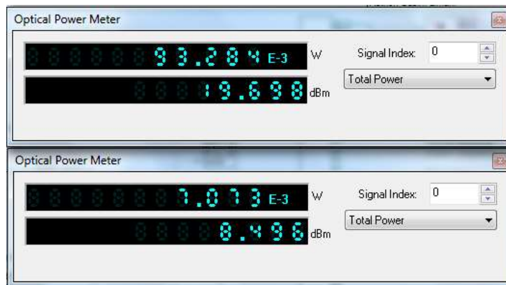
Figura 96. Fuqia e sinjalit transmetues në dalje të multiplekserit dhe në hyrje të demultiplekserit duke përdorur EDFA.
