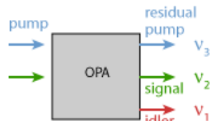
Figura 89. Skema e përforcuesit parametrik optik (OPA). (www.dariopolli.wordpress.com)
