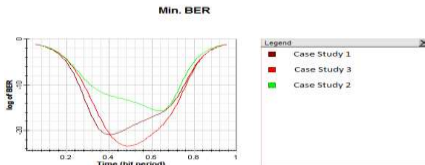
Figura 157. Vlera minimale e BER-it, në kapacitet 10 Gbps, në kanalin e parë me EDFA
