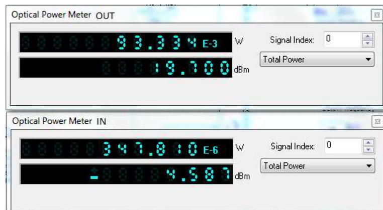
Figura 134. Fuqia e sinjalit transmetues në dalje të multiplekserit dhe në hyrje të demultiplekserit.
