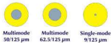
Figura 4. Pamja tërthore e diametrit të fibrave optike single-mode dhe multi-mode ( http://networkengineering.stackexchange.com )
