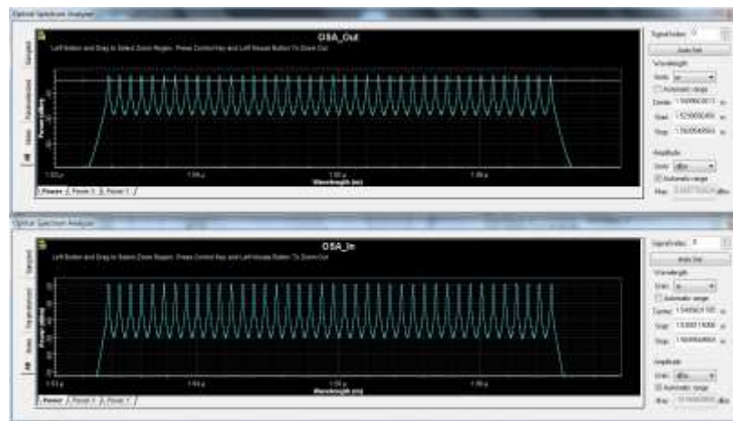
Figura 92. Matjet e fuqisë së sinjalit optik me Analizues të Spektrit (Spectrum Analyzer).
