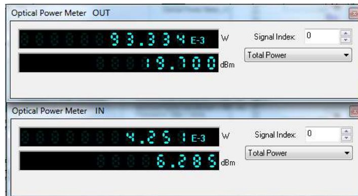
Figura 139. Fuqia e sinjalit transmetues në dalje të multiplekserit dhe në hyrje të demultiplekserit duke përdorur EDFA.
