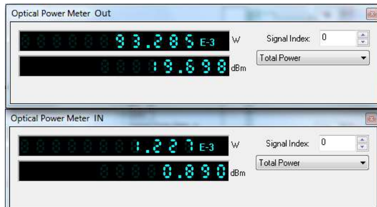
Fig. 118. Fuqia e sinjalit transmetues në dalje të multiplekserit dhe në hyrje të demultiplekserit duke përdorur EDFA.
