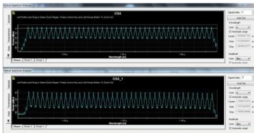
Figura 129. Matjet e bëra me optical spectrum analyzer në dalje të multiplekserit dhe në hyrje të demultiplekserit.
