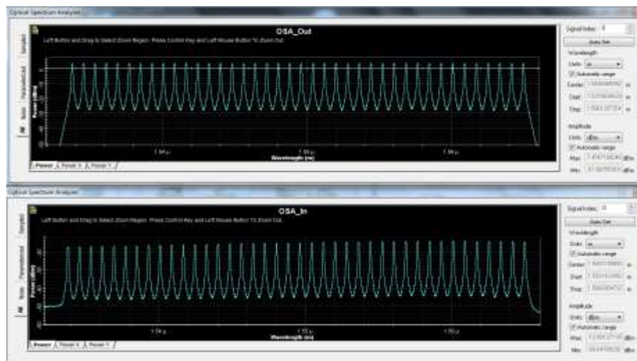
Fig. 118. Fuqia e sinjalit transmetues në dalje të multiplekserit dhe në hyrje të demultiplekserit duke përdorur EDFA.
